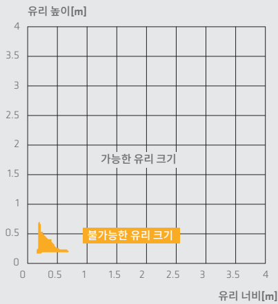
그림 21 주거용 창호 유리: 4/12/4 mm, p_0 : 12kPa 씰링 깊이: 6 mm
