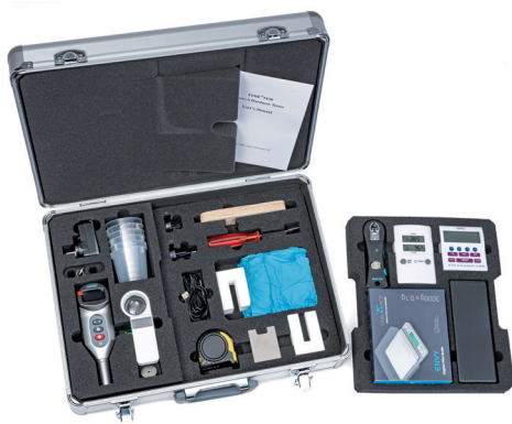
Sikasil® SG 및 Sikasil® IG 접착제 적용 시 품질 관리를 위한 테스트 키트
